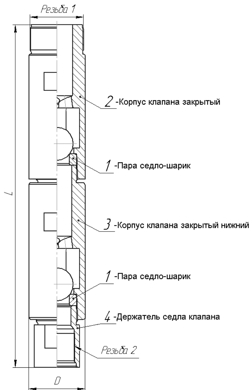
Клапан всасывающий сдвоенный в сборе насосов НВ
